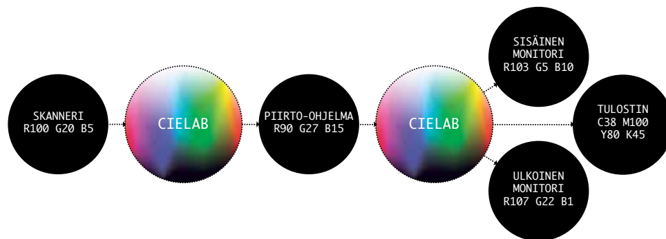
Kuva 1: Yhden pikselin matka väriprofiiloidun vuon läpi. Absoluuttinen väri on joka kohdassa sama, mutta sen esittämiseen tarvitaan kussakin laitteessa eri numeroarvot.
